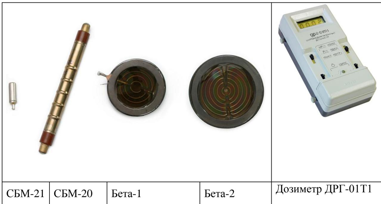
В приборе используются четыре счетчика СБМ-20 (чувствительный канал) и два счетчика СИ-34Г (грубый канал). Диапазон измерения от 10 мкР/ч до 10 Р/ч в диапазоне энергий 50 кэВ – 3 МэВ. Номер в Государственном реестре средств измерений №11036-04. Заявленная производителем ОАО "Механический завод" (С.-Петербург) и подтвержденная Центром испытаний средств измерений основная относительная погрешность в режиме «Измерение»  $\pm[15 + 0,05(y/x-1)]\%$ ,
